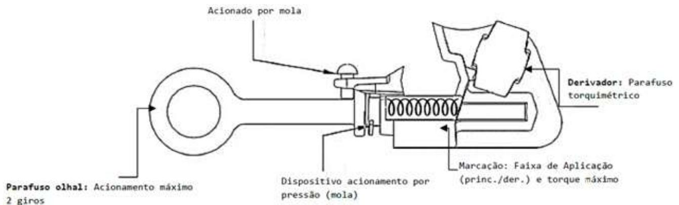
**Figura 1** - Grampo de linha viva torquimétrico
